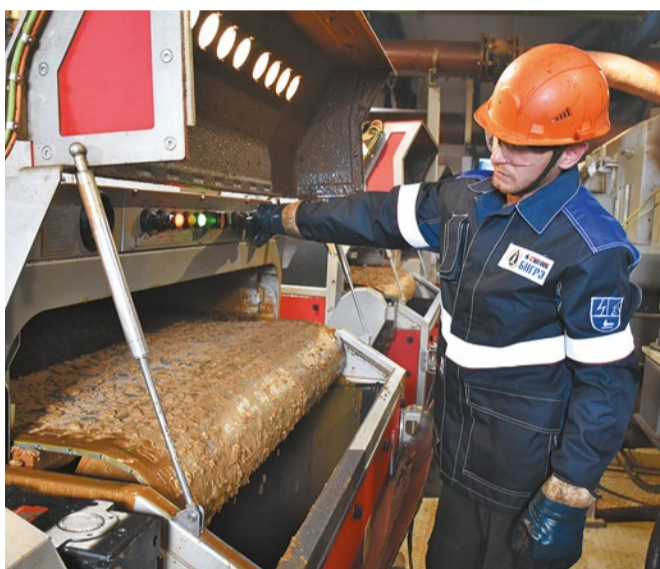
Помощник буровика 5-го разряда ООО «БНГРЭ» Алексей Шишов контролирует работу оборудования MudCube
